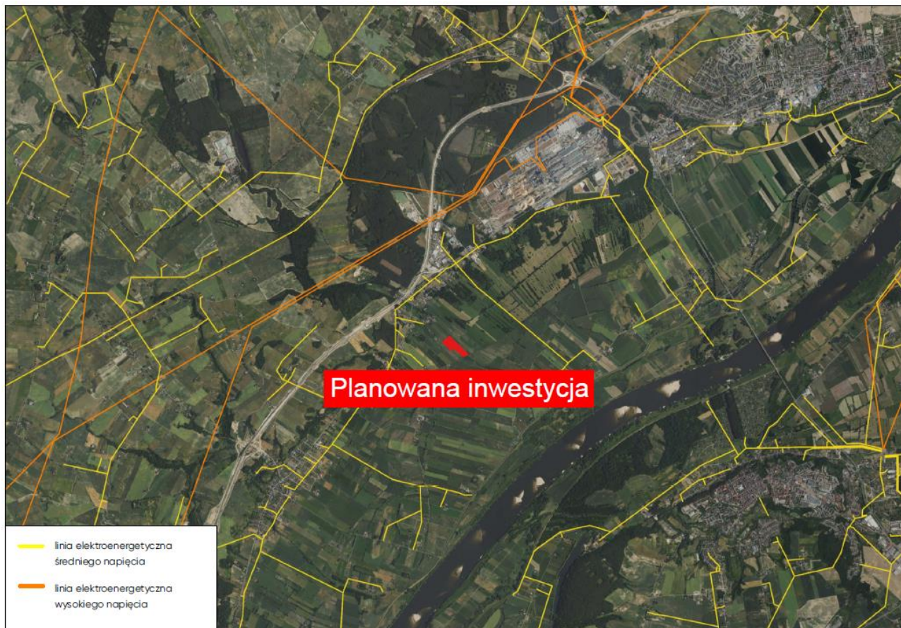
Ryc. 22 Lokalizacja planowanej inwestycji względem istniejących linii SN i WN Źródło: Opracowanie własne.
