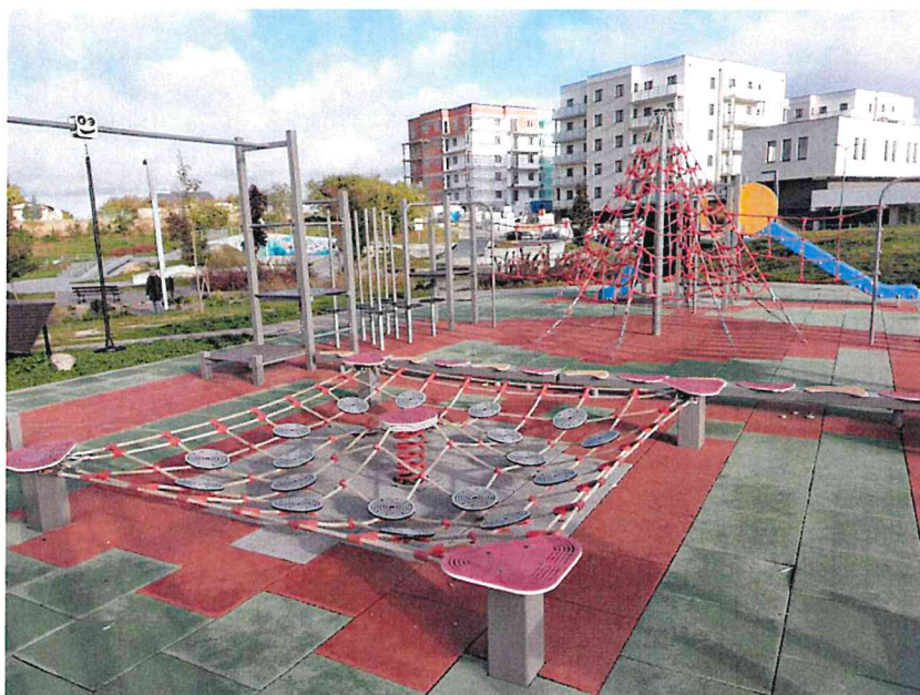
Zdjęcie nr 18. Wyposażenie placu zabaw na nawierzchni bezpiecznej z granulatu gumowego wielokolorowego.
