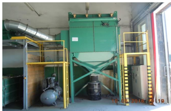
Rysunek 30 Tak jest. Sortownia odpadów komunalnych zmieszanych i selektywnie zebranych – separator powietrzny, Puszcza Miejska (foto. Puszcza Miejska, październik 2015r.)
