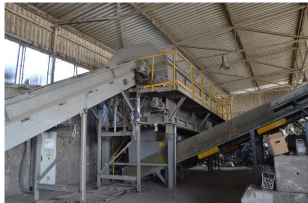
Rysunek 50 Tak jest. Nowa sortownia odpadów komunalnych zmieszanych (sortowanie wstępne), Remondis Bydgoszcz (foto: Remondis Bydgoszcz,
