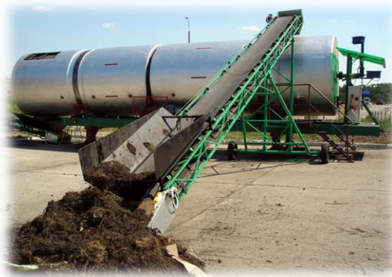
Rysunek 42 Komposter do przetwarzania odpadów zielonych, Machnacz (foto „Saniko” 2013r)
