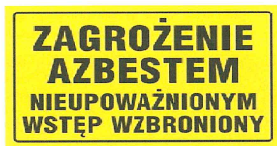
Ryc. 4. Wzór tablicy informacyjnej umieszczanej podczas prac związanych z usuwaniem wyrobów azbestowych (źródło: „Co z tym azbestem?”- poradnik dla właścicieli i zarządców nieruchomości, Federacja Zielonych Gaja, Szczecin 2012).
