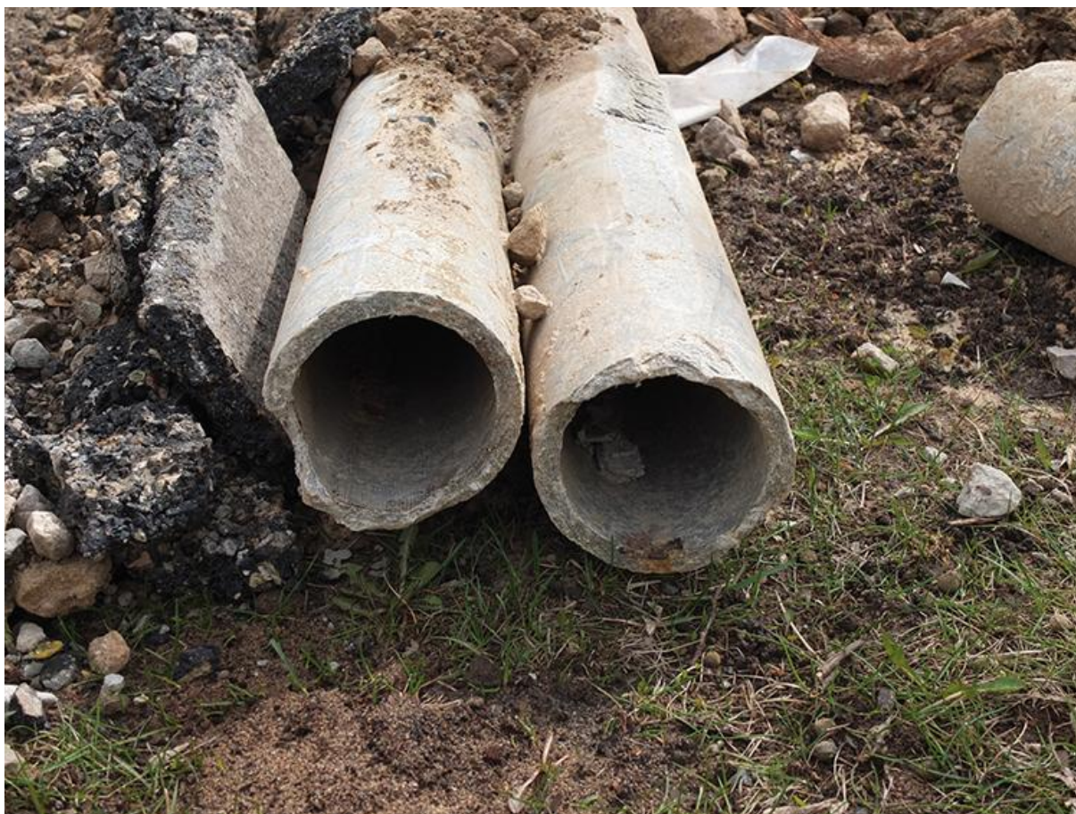
Rys. 7. Rury azbestowo-cementowe stosowane m.in. jako przewody wodociągowe i kanalizacyjne (źródło: Fot. stock.adobe/chuck1964).
